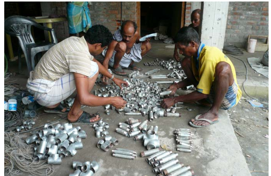
Oben: Unsere Eisenflechter mit ihren selbst erfundenen „Zunftmützen“. Unten: Fittings für die Wasserleitungen werden sortiert. Bevor wir sie kaufen überprüfen wir jedes einzelne Gewinde. Das dauert oft Stunden.
